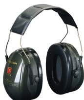
Cuffia protettiva CE Adatta in ambienti industriali particolarmente rumorosi o aeroporti e quando si utilizzano macchine in movimento a terra o agricole. DATI ATTENUAZIONE SNR 31 dB H = 34 dB M = 29 dB L = 20
