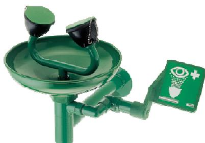
Lavaocchi a parete con vaschetta. Installazione: A parete, con montaggio rapido di componenti preassemblati. Manutenzione facile delle valvole estraibili ed ispezionabili. Materiali: Tubi in acciaio zincato, raccordi in ottone; il tutto ricoperto da verniciatura epossidica anticorrosiva. Vaschetta in ABS, spruzzo aerato e regolato. Pressione min.: 2 bar. Portata: 12L/min. CE - DIN 12 899 - UNI 9608.
