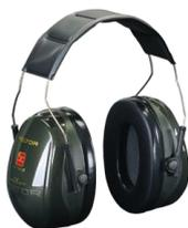
Cuffia protettiva CE Adatta in ambienti industriali particolarmente rumorosi o aeroporti e quando si utilizzano macchine in movimento a terra o agricole. DATI ATTENUAZIONE SNR 31 dB H = 34 dB M = 29 dB L = 20
